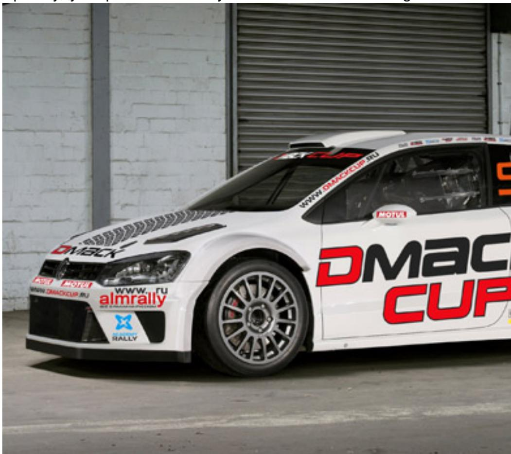
За основу будущего раллийного болида взят трехдверный кузов, при этом двигатель АЛМовцы станут готовить сами. Дело в том, что серийные 1600-кубовые моторы для Polo в Европе не производятся, и потому получить искомый рабочий объем планируется за счет установки в двигатель 1.4 коленвала и поршней от других серийных моторов концерна Volkswagen.
