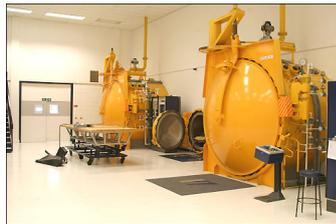
После того, как элемент готов, его нужно "запечь" в автоклаве, чтобы смола разных слоев полимеризовалась. Деталь запаивается в пакет из специального прозрачного термопластика, вакуумной машиной откачивается воздух, что не позволяет смоле менять форму при нагревании.
