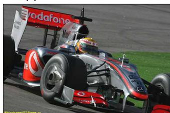
На зимних тестах машина уступала соперникам около двух секунд с круга, по меркам Формулы 1 отставание огромное. MP4-24 серьёзно не хватало прижимной силы, и большую часть программы Хэмилтон и Ковалайнен отработали с прошлогодним задним антикрылом.
