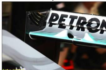
В Mercedes для своей домашней гонки приготовили целый комплекс небольших обновлений и одно весьма заметное: речь о главном профиле заднего крыла, на центральной секции которого появилось любопытное решение. Благодаря отверстиям, которые видны на рисунке и на фотографии, этот элемент позволяет добиться некоторого повышения прижимной силы, что было весьма кстати в Хоккенхайме и еще больше пригодится в Венгрии в следующий уик-энд.
