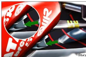
Конструкторы Ferrari внесли изменения в выхлопную систему F10 и доработали боковые каналы диффузора.
